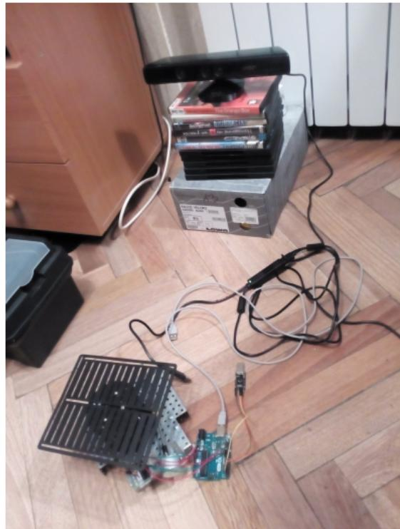
Kinect поднят для того, чтобы был виден верх образца.
