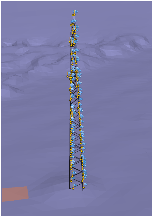
(b) Вставленная опора ВЛ-220 (вид сбоку)
