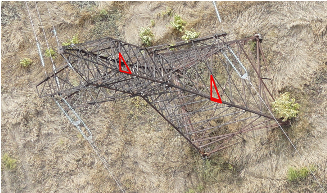
Рис. 4.1: Треугольники, обнаруженные алгоритмом PylonByTriangles
