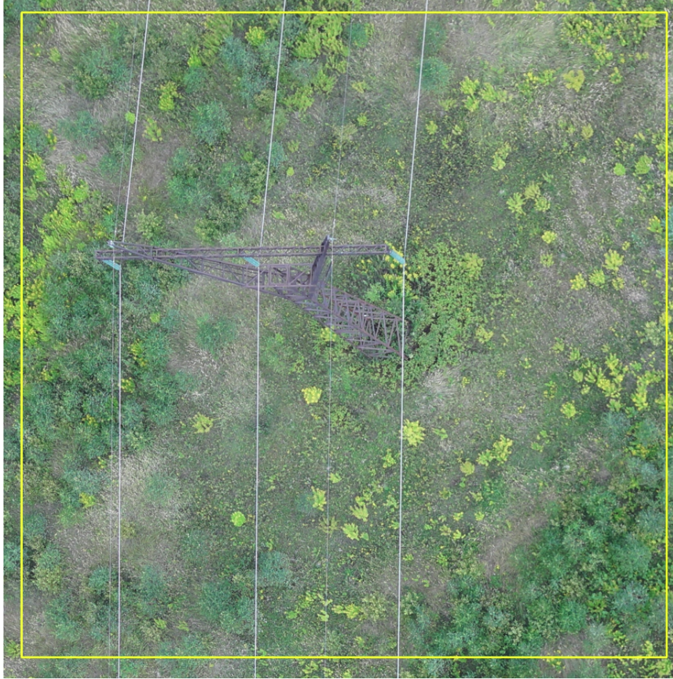
Рис. 4.2: Пример области с опорой, выделенной алгоритмом
