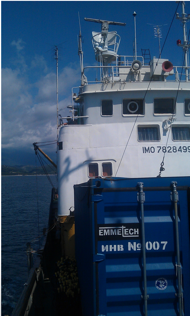
Судно «Аксиома». На переднем плане находится контейнер со станциями. На борту установлена гидроакустическая штанга с GPS антенной.
